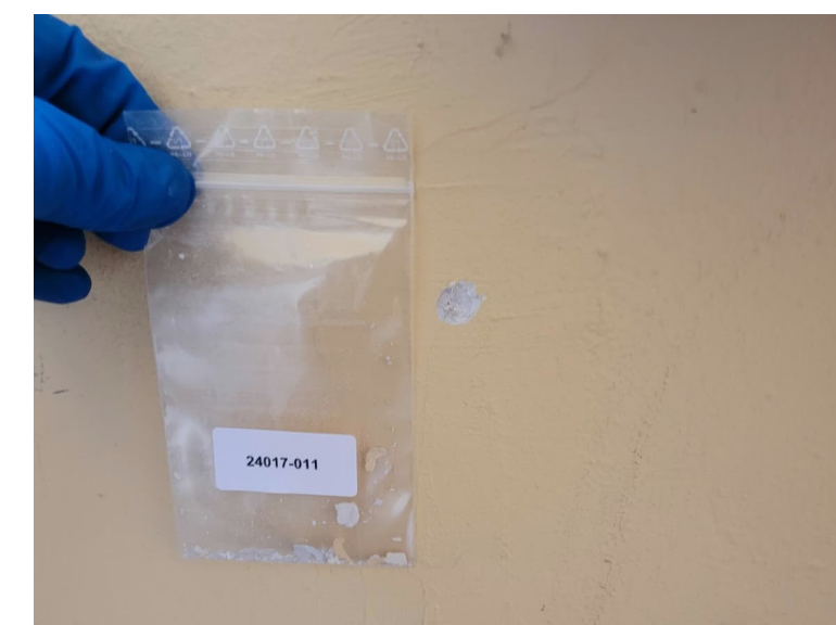
1 Asbesthaltige Spachtelmassen an Heizkörpernische
