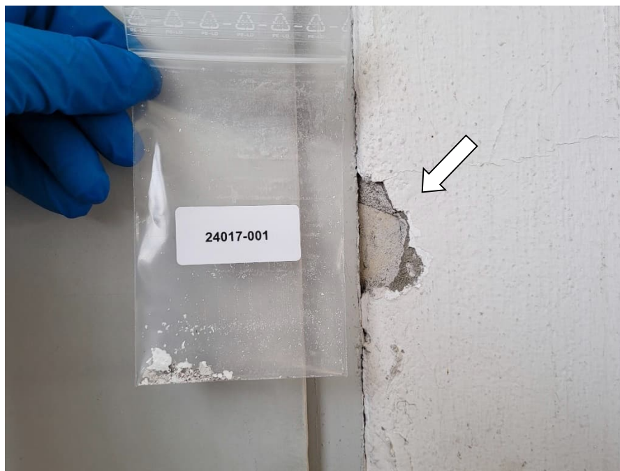
EG, Fahrzeughalle Wandfarbe Spachtelmasse Putz Türleibung (Mischprobe 24017-001: kein Asbest nachgewiesen)
