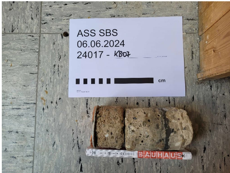
EG, Gruppenraum, Kernbohrung 07 5mm Bodenbelag, 55mm Estrich, >150mm Beton
