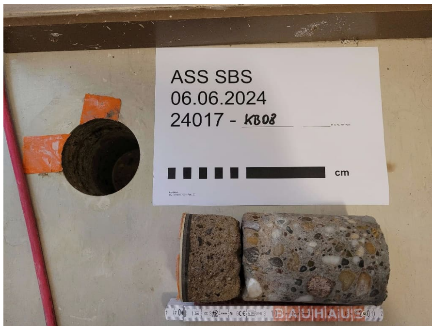
EG, Eingang Schützenstraße, Kernbohrung 08 3mm Bodenbelag, 5mm Kleber und Ausgleichsmasse, 55mm Estrich, >150mm Beton
