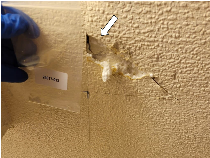
UG, Technik PS-Kleber Decke (Probe 24017-013: kein Asbest nachgewiesen)
